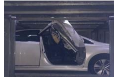
ブレーキユニットの劣化による車両損傷
